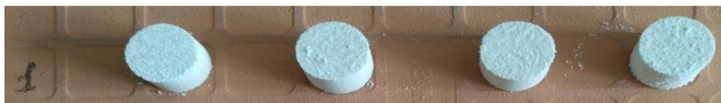
Рис. 2. Отпрессованные термообработанные таблетки шихты
