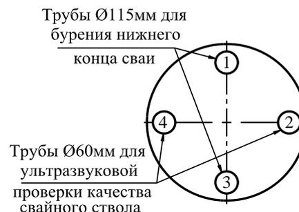
Рис. 6. Установка труб для ультразвукового контроля качества ствола сваи и бурения ее нижнего конца
