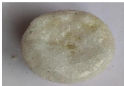
Рис. 5. Силикат-глыба с 26 % Na<sub>2</sub>O
