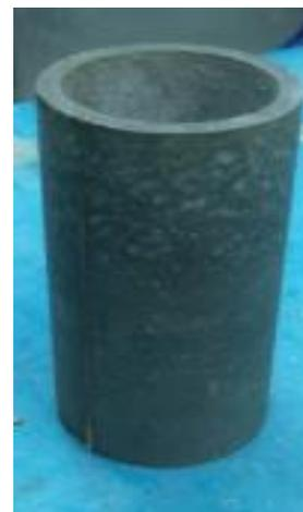
Рис. 3. Образцы из центрифугированного бетона перед тепловлажностной обработкой
