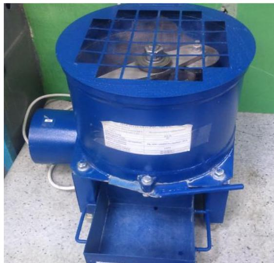
Рис. 2. Бетоносмеситель лабораторный БЛ-10
