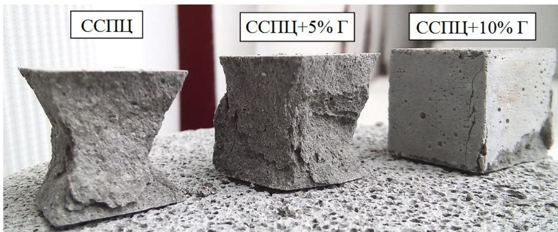
Рис. 3. Характер разрушения образцов при испытании на прессе
